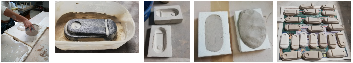
Molde para probetas y primeras probetas de pasta con nepheina, fotos obtenidas de: UAM Xochimilco, edificio , 2022.
