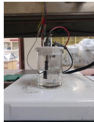
Fig. 6a) Esquema de electrodo de grafito, b) Instalación de la celda electroquímica con los 3 electrodos
