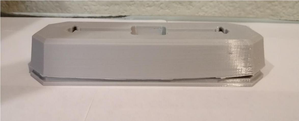
Imagen 5.2 Fallas y resultados de impresiones en 3D del sistema de pegado de dardos.
