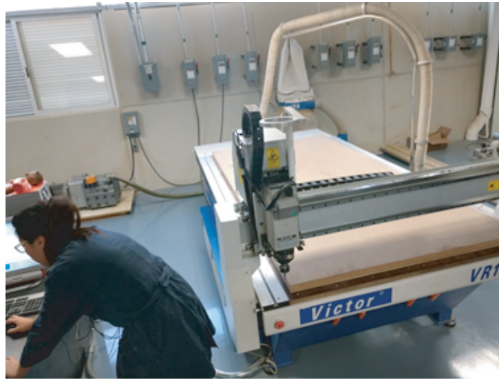
Figura 7. Manejo del programa plug-in Rhinocam y la máquina de CNC.
