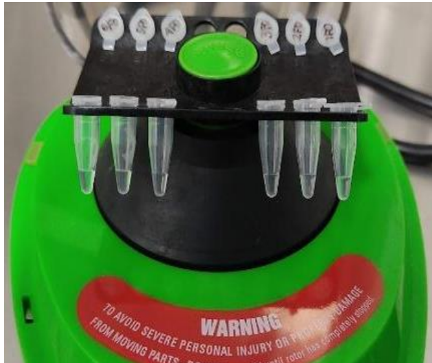
Foto 8. Centrifuga, su principal función es bajar cualquier gota de muestra que haya quedado en la pared del tubo, de igual manera sirve para quitar las pequeñas burbujas que tiene la muestra.
