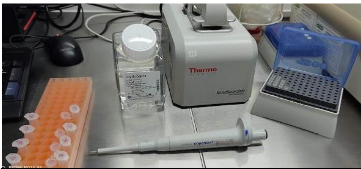
Imagen 2. Verificación de calidad en absorción 260/280 y concentración en \mu\text{g}/\mu\text{L} de muestras de ADN.
