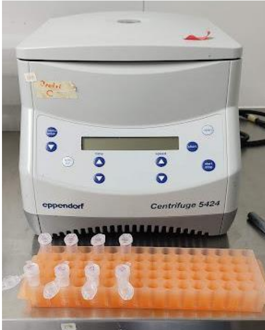
Foto 5. Centrifuga para meter muestras a un cierto número de rpm.
