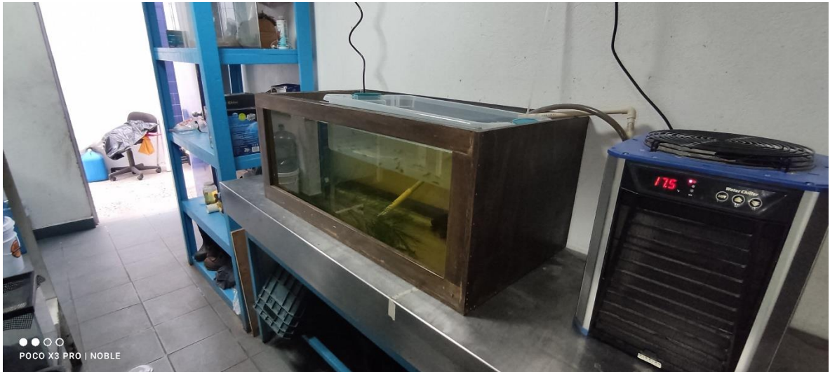
Figura 9. Acuario de larvas de ajolotes de proyecto de maestría con chiller instalado a 17.5°C.
