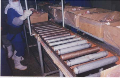
EQUIPO OXIDADO EN ZONA DE EMPAQUETADO.
