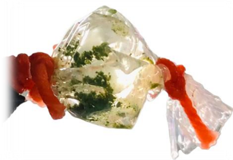
Figura 13. Muestra de la MOF-74(Cu) en la membrana de diálisis después de perfil de liberación en vaso enchaquetado con flujo de agua a temperatura constante.
