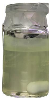
Figura 10. Muestra de MOF-74(Cu) al término de la prueba de degradación ácida.
