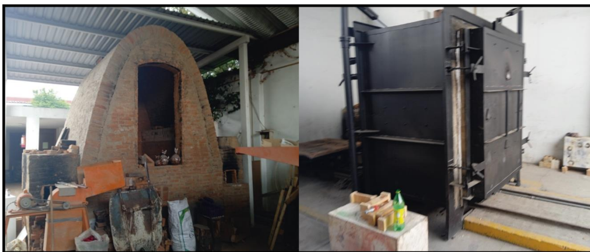
Figura 20. Horno sin humo (izquierda) y horno de gas LP (derecha), ambos habilitados en el Centro de Desarrollo Artesanal (CDA)
