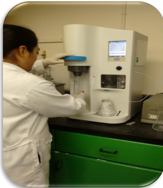
Imagen 2. Uso de UDK 129, Velp, Italia para el análisis de proteína cruda, mediante el método de micro-Kjeldahl.
