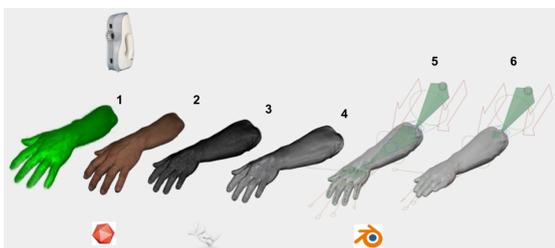
*Figura 8 Modificación postural de escaneo 3D. 1) Nube de puntos obtenido con Artec EVA. 2) Modelo procesado con Artec Studio 17. 3) Malla poligonal de caras triangulares. 4) Retopología de malla poligonal cuadrangular. 5) Animación esquelética, disposición de los huesos en el modelo con retopología. 6) Modificación postural.*
