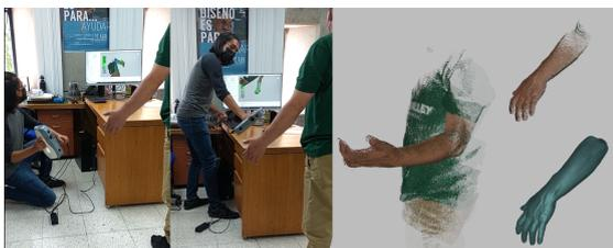
*Figura 6 Alineación de modelos de mano. Muestras 2 y 21. En vista con textura (derecha en medio) se observa la malla poligonal resultante con una deficiente calidad de la geometría.*
