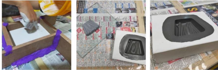
10.2 Molde terminado y primeros vaciados en resina.
