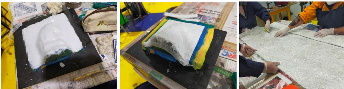
2.1 Preparación del molde, silicón y corte de la fibra de vidrio
