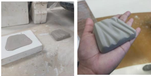
10.4 Termoforma do de piezas y vaciado de silicón
