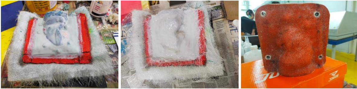
2.2 Segunda capa del molde y molde ya terminado
