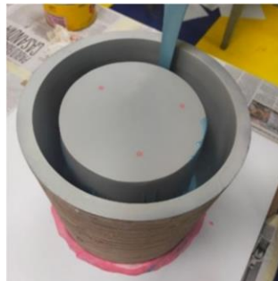
4.2. Armado del molde, lijado y vaciado de rellenor
