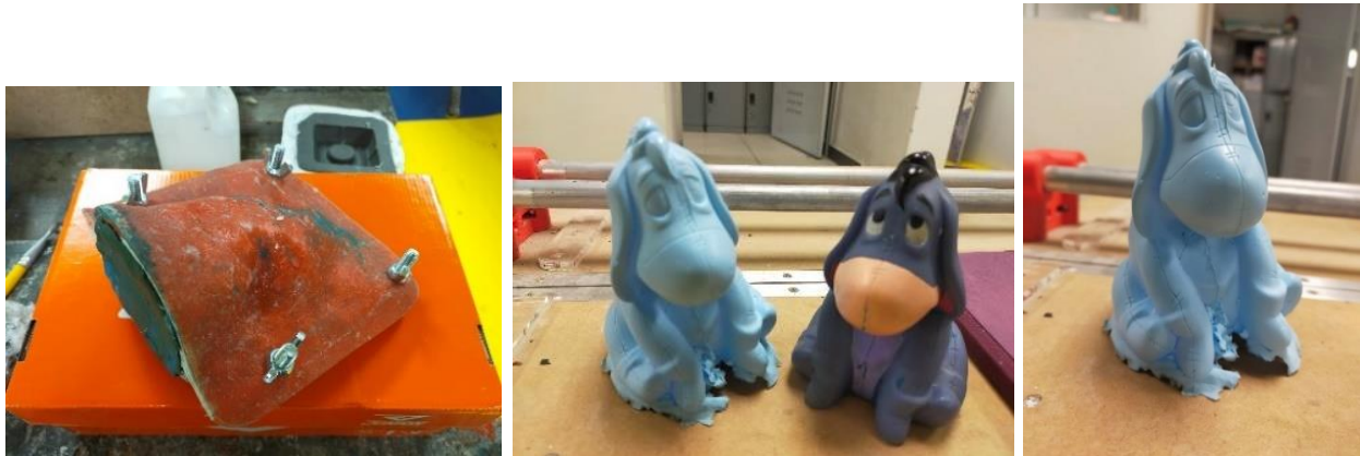
2.3 Molde final y reproducciones en resina Smooth Cast
