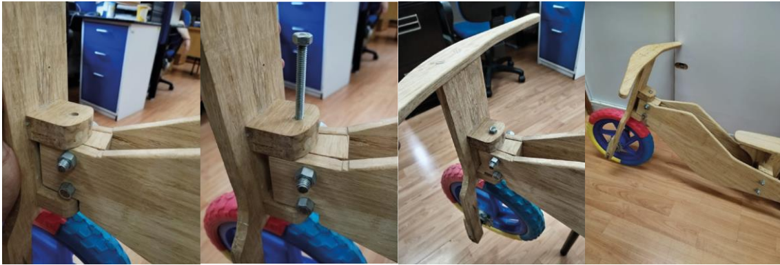
Ensamble del cuerpo y horquilla, fuente: Jorge Arevalo,2022
