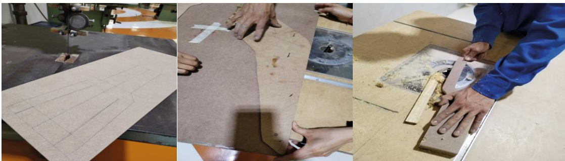
Corte y rauteado de las piezas. fuente: Jorge Arevalo,2022
