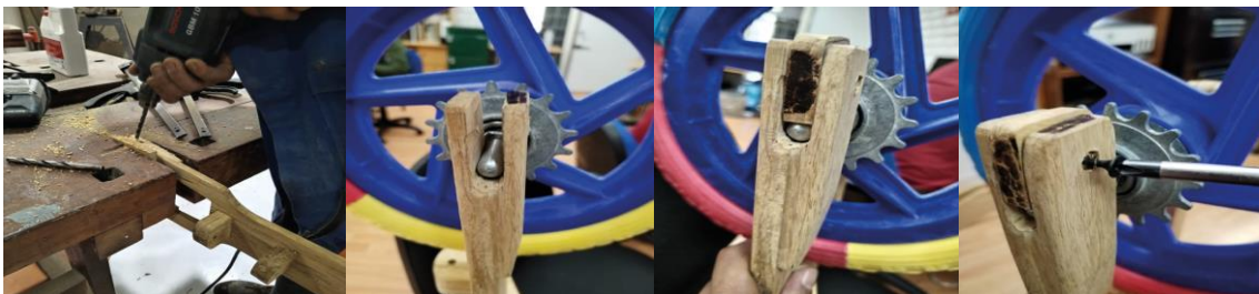
Barrenado y ensamble de la horquilla. fuente: Jorge Arevalo,2022
