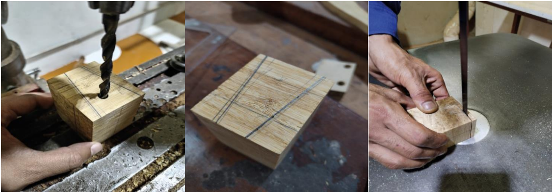
Corte y ensamble de la junta frontal. fuente: Jorge Arevalo,2022
