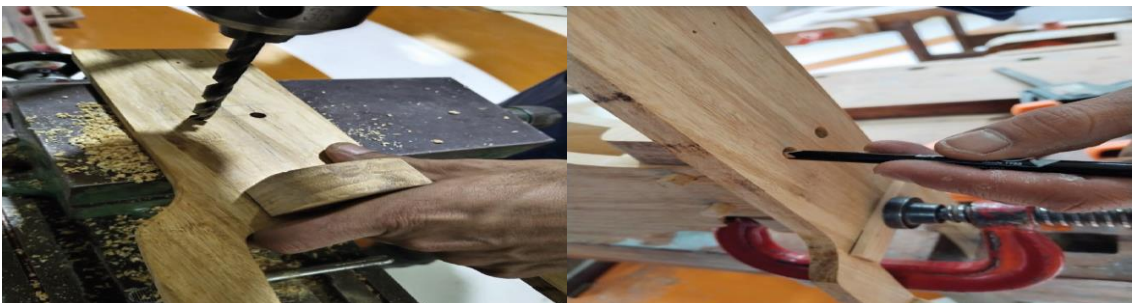
Barrenado de horquilla y unión frontal ,fuente: Jorge Arevalo,2022
