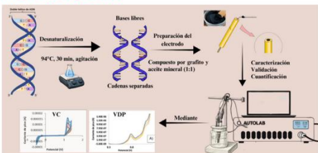
Figura 1. Proceso para la cuantificación de ADN. Todas las mediciones se realizaron por voltametría cíclica (VC) y voltametría de pulso diferencial (DPV) en NaCl 0.1 M y buffer acetato pH 4.5.
