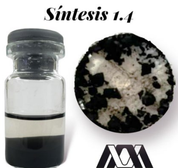
Figura 2. Imagen de nanopartículas de hierro resultantes de la síntesis 1.4. Lado izquierdo: de vial conteniendo dispersión coloidal en metanol con sedimento; lado derecho: partículas de residuo sólido secado a temperatura ambiente.
