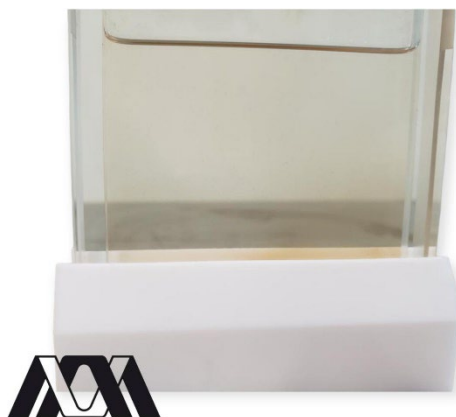
Figura 4. Imagen de la celda de fracción de 20 mL empleada para la medición de tamaño de partícula por difracción láser.
