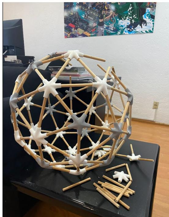
*En las imágenes anteriores se muestran los conectores de 5 y 6 cavidades los cuales debían colocarse alternadamente para que dieran forma a la lámpara.*
