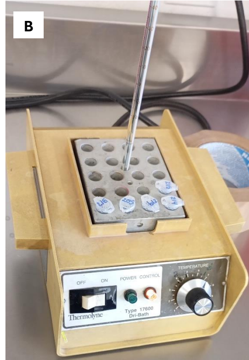
Figura 6. A) Protocolo para la extracción de DNA mediante lisis alcalina (elaboración propia). B) Thermoblock usado para el control térmico de la lisis alcalina de las biopsias.
