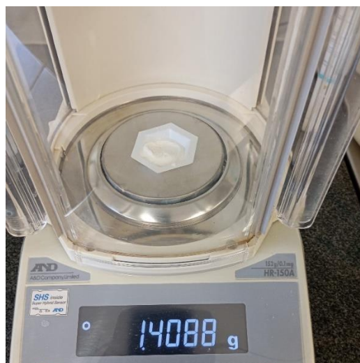
Figura 3. Se debía pesar una masa de polvo calculada, a partir del porcentaje y el volumen requerido. Ejemplo peso 1.4088 g de agarosa. Tras disolver el reactivo sólido en una alícuota, la solución se llevó al volumen final en una probeta graduada.
