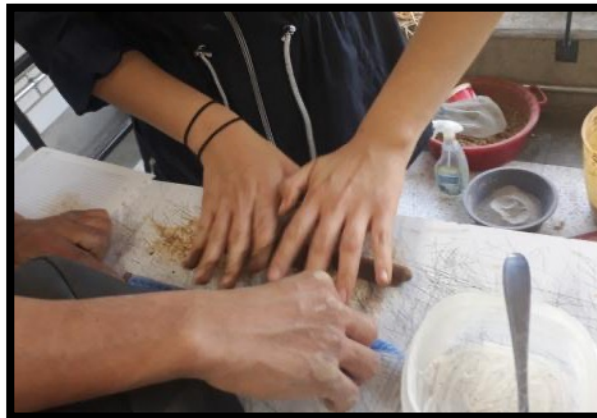
Imagen 14 "Prueba del churro para mezcla principal"
