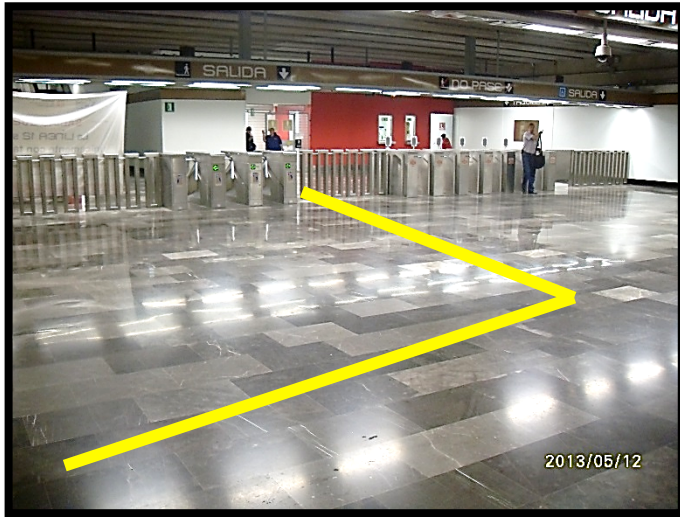
ESTACION MIXCOAC: FALTA LA INSTALACION DE LA GUIA TACTIL PARA INVIDENTES EN EL VESTIBULO Y ACCESO
