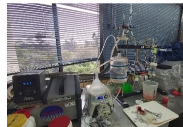
Ilustración 8. Equipo Langendorff formado por: A) regulador circulatorio de temperatura, B) bomba peristáltica, C) solución Krebs y D) sensores de presión arterial y frecuencia cardíaca.
