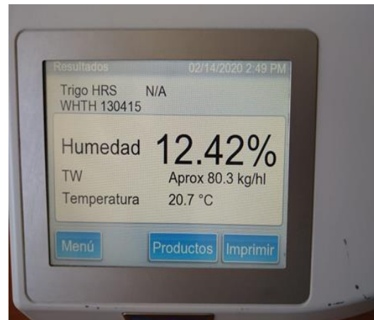
Figura 5. Medidor "AM 5200" y pantalla de resultados de % de humedad y temperatura del grano.
