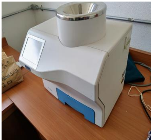
Figura 5. Medidor "AM 5200" y pantalla de resultados de % de humedad y temperatura del grano.
