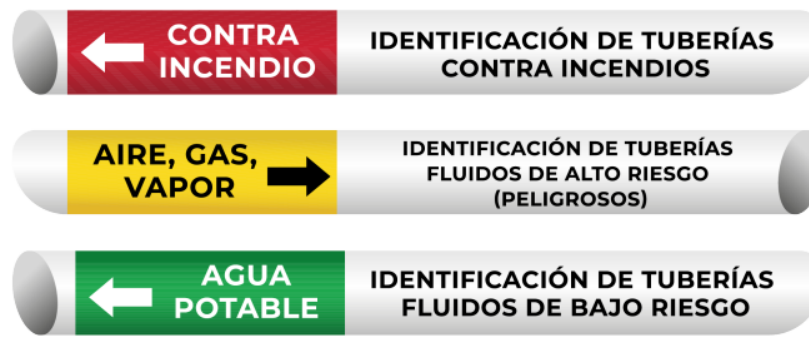
Figura 1. Identificación de tuberías.
