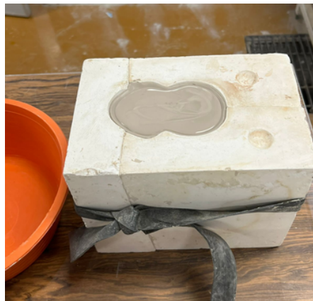
Figura 9. Vaciados con la primera prueba de barbotina
