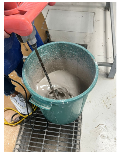
Figura 7. Primer preparación de barbotina
