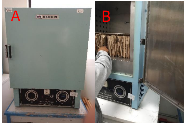
Figura 6. A) estufa de secado, B) ingreso de las muestras a la estufa.
