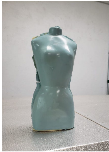
Figura. 5: Reproducción de relleno plástico y espuma de poliuretano
