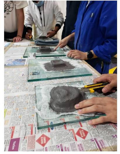
Figura. 3: Molde sencillo de una cavidad con silicon Molduflex
