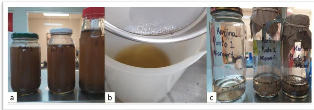
**Figura 3.** Aplicación del método de flotación descrito por Snider y Snider. a) Frascos con 50 g de suelo de cada sitio de muestreo con solución saturada de azúcar, en reposo. b) Decantación de las muestras, reteniendo el contenido flotante en un tamiz de malla no. 200. c) Frascos con materia orgánica recuperada conservada en alcohol al 70%.
