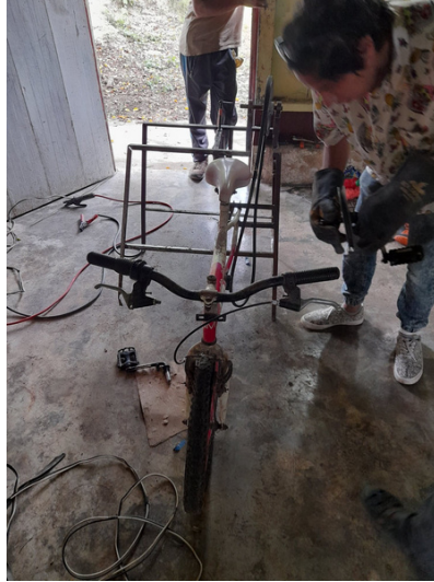
Soldadura del bicimolino.
