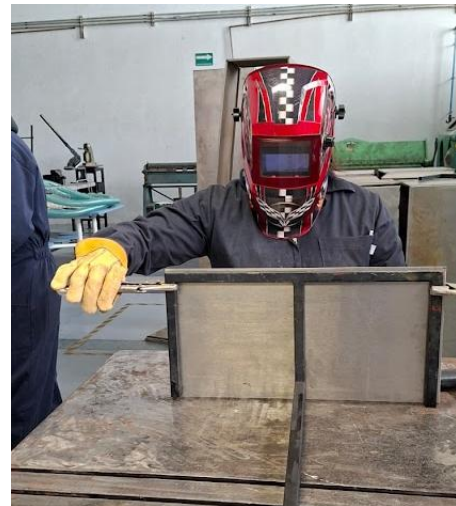
Imagen 42 y 43: Soldado de perfil base para "Elaboración de "Semáforo de la Sustentabilidad UAM Xochimilco."
