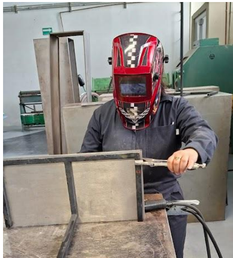
Imagen 42 y 43: Soldado de perfil base para "Elaboración de "Semáforo de la Sustentabilidad UAM Xochimilco."
