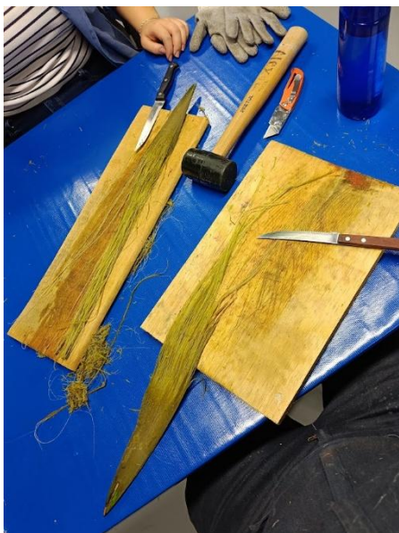
Imagen 18 y 19: Cepillado y extracción de fibras de agave para "Pruebas de la aplicación de fibras de agave azul para el diseño."
