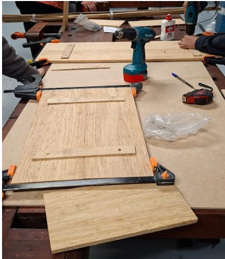
Imagen 39: Prensado de laminado de bambú "Elaboración de "Semáforo de la Sustentabilidad UAM Xochimilco."
