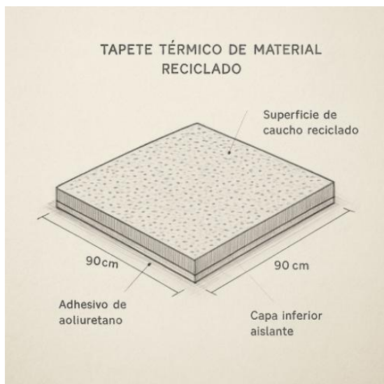
Imagen 28: Propuesta 1 con gránulos de caucho reciclado "Propuesta de diseño de tapete para lechones."
