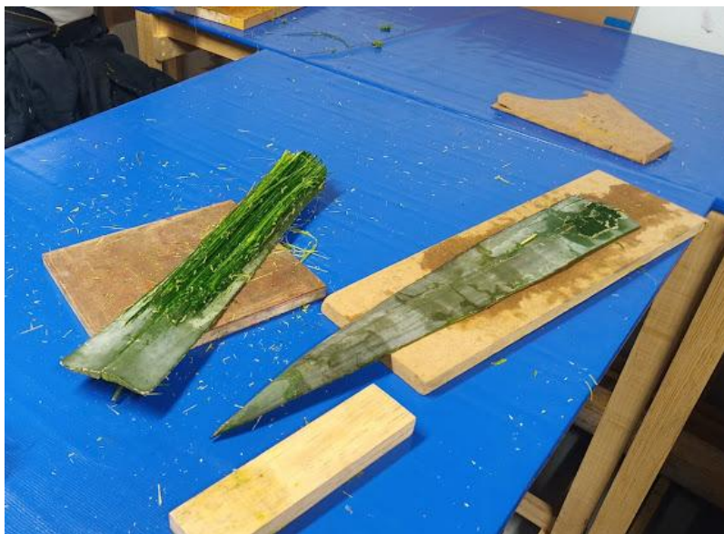
Imagen 18 y 19: Cepillado y extracción de fibras de agave para "Pruebas de la aplicación de fibras de agave azul para el diseño."
