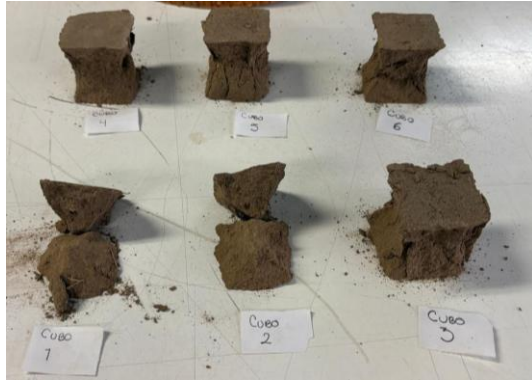
IMAGEN 7: CUBOS DEFORMADOS POR LA COMPRESION (Daniela V. Grimaldo B. 11 MARZO 2026, fotografía propia).
