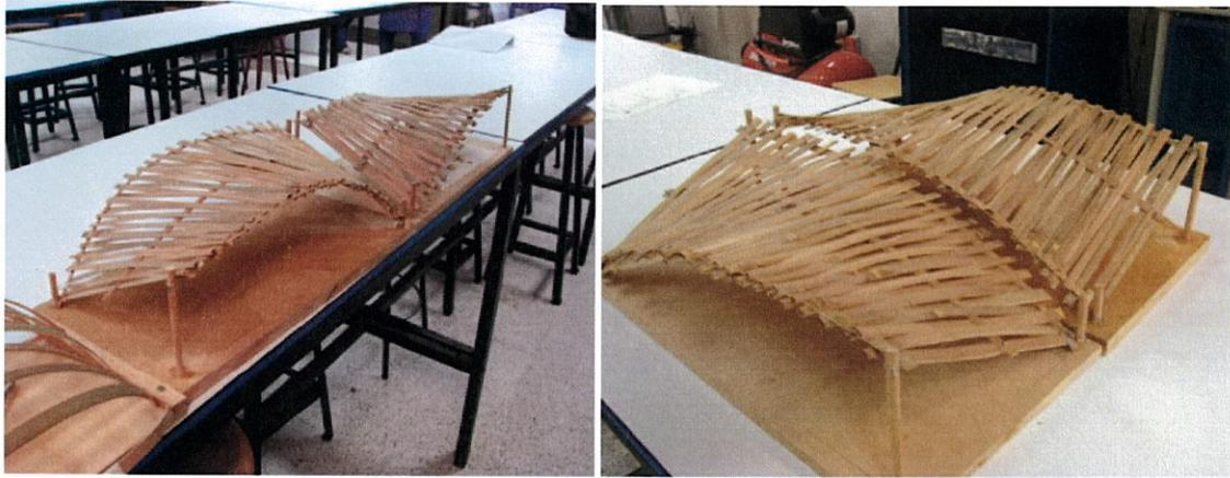
Cubierta de 50 cm x 30 cm, se entrelazan los bambús unos con otros, para obtener una rigidez Y que la estructura sea capaz de mantener su propio peso.
