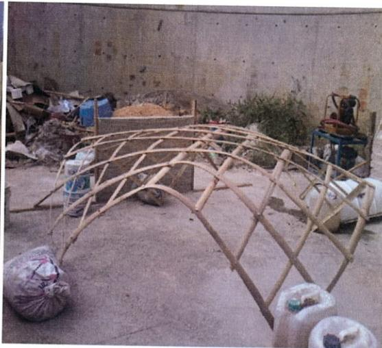
Cubierta de 3x3 metros, en forma reticulada de 30cm, se sujetaron con tornillos, la finalidad es la de que al aplicarse una fuerza esta se deforme para adquirir una nueva forma que uno desea, pero que sea capaz de soportar su propio peso y rigidez sin necesidad de que se le ponga un tensor.
