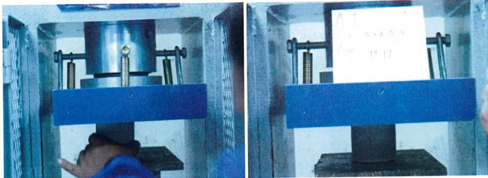
Colocación del BTC para realizar la prueba.
