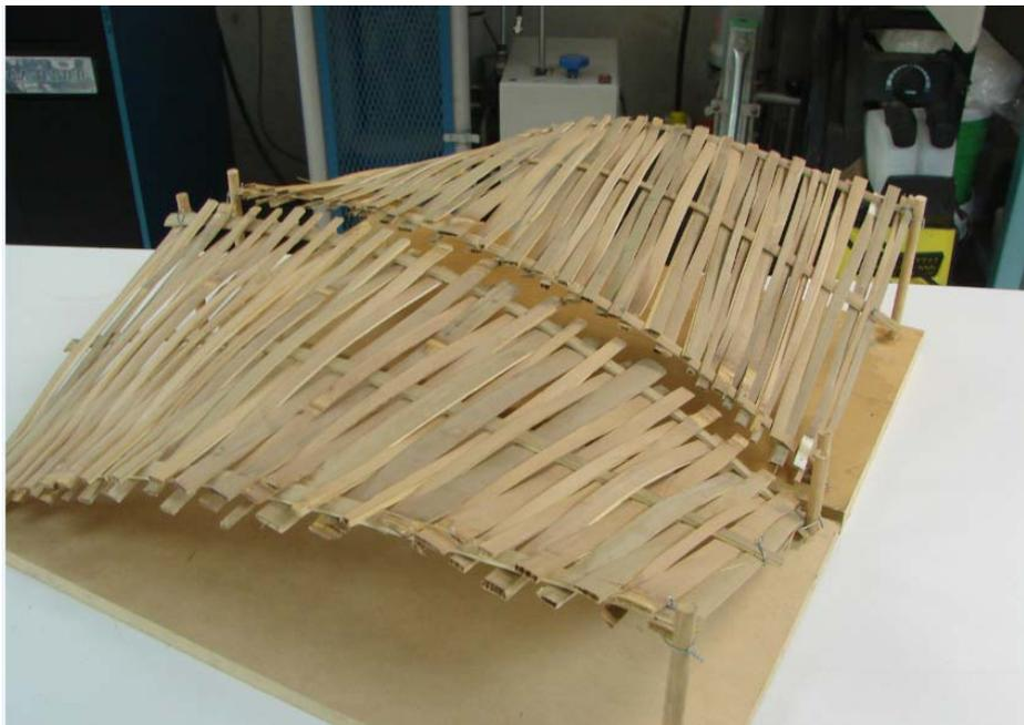
Propuesta de cubierta escala 1:50 con dos columnas de apoyo. El bambú se cortó en tiras de 1 cm aproximadamente por 25 cm de largo para el lado corto y de 40 cm para el lado
