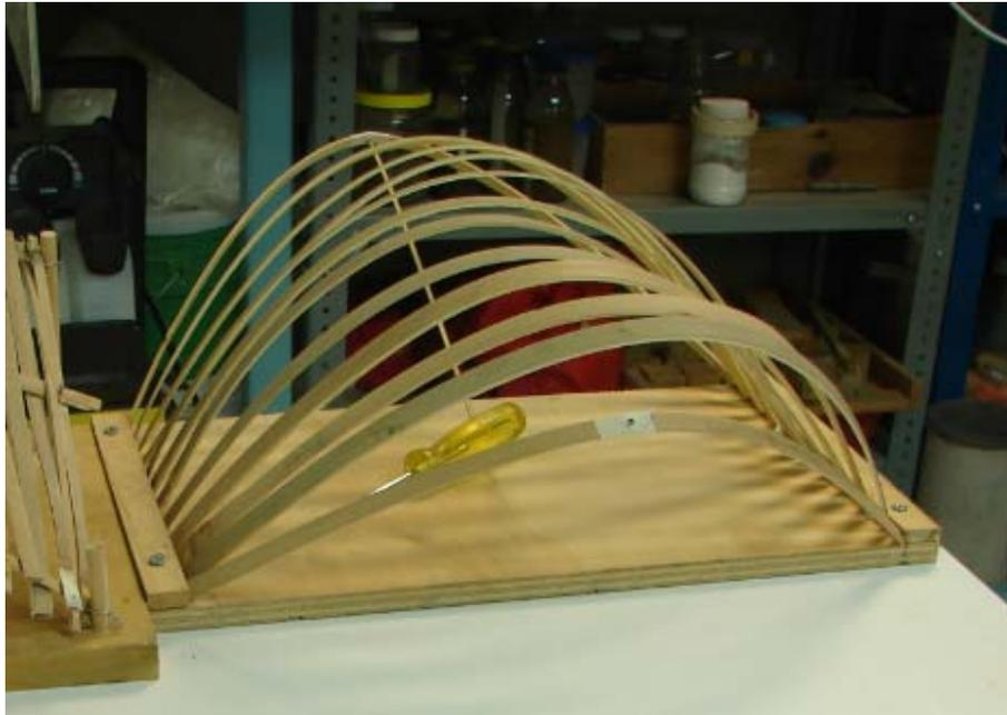
Cubierta escala 1:50 tipo domo usando el concepto de compresión para mantener la forma. Se utilizó tiras de 1 cm aproximadamente con largo variado.
