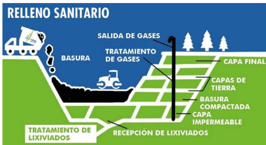
Funcionamiento de un relleno sanitario
