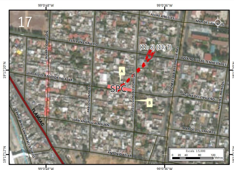
Ilustración 22: Mapa peligro por hundimiento y fracturamiento. Fuente: Atlas de Peligros y Riesgos de la Ciudad de México, Delegación Tláhuac. Nota: las líneas rojas discontinuas indican el fracturamiento inferido, el color coral indica el sitio con riesgo Ojo de Agua, la línea azul indica un canal natural.
