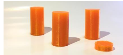
Figura 5. Impresión 3D de piezas con polímero PLA, impresora Flashforge.
