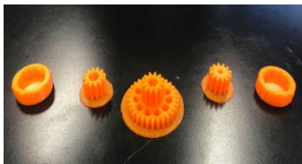
Figura 5. Impresión 3D de piezas con polímero PLA, impresora Flashforge.
