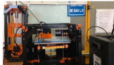
Impresora preparada para impresión 3D con Pasta Cerámica
