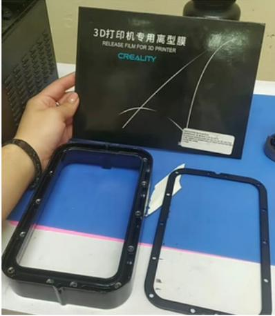
Imagen 28 - Cambio de la mica de impresión.
