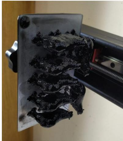
Imagen 4 - Impresión 3D en resina, de borregos a escala.
