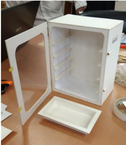
Imagen 1 - Modelo a escala del biorreactor.
