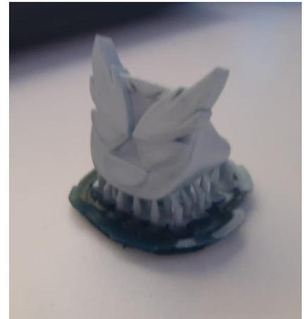
Imagen 27 - Impresión 3D en resina del anillo "Smash"
