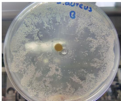
Figura 8. Prueba de actividad antimicrobiana de la fracción metanólica 2 (B) del aislado 546 con el microorganismo S. aureus , por difusión en papel.
