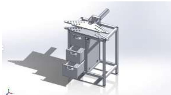
Anexo 11 Modelado de dobladora y de la base para la misma.
