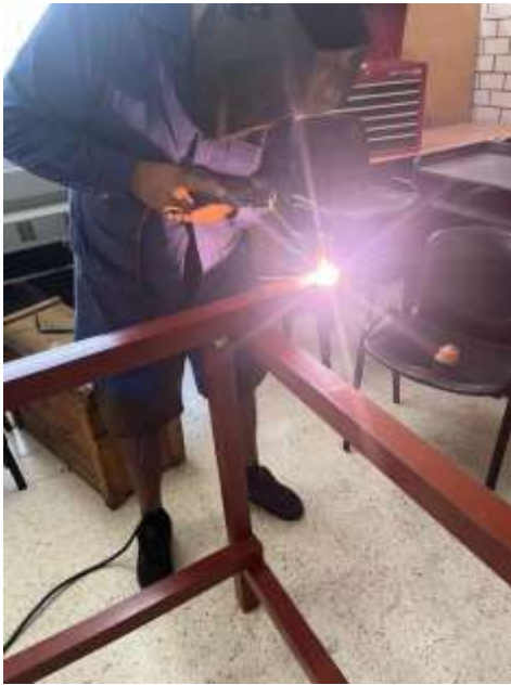
Anexo 08 Materialización de la estructura principal de la mesa.
