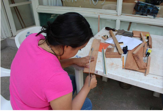
Construcción de largueros para bastidor del entablamento.
