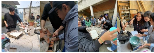
[Fotografías de Práctica de dosificación de morteros de cal y arena]. (2023). Archivos de LITec.
