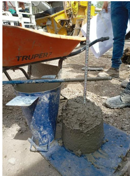
Imagen 2. Prueba de revenimiento. U.H Leyes de Reforma. 5 de diciembre del 2023. (Autoría propia).
