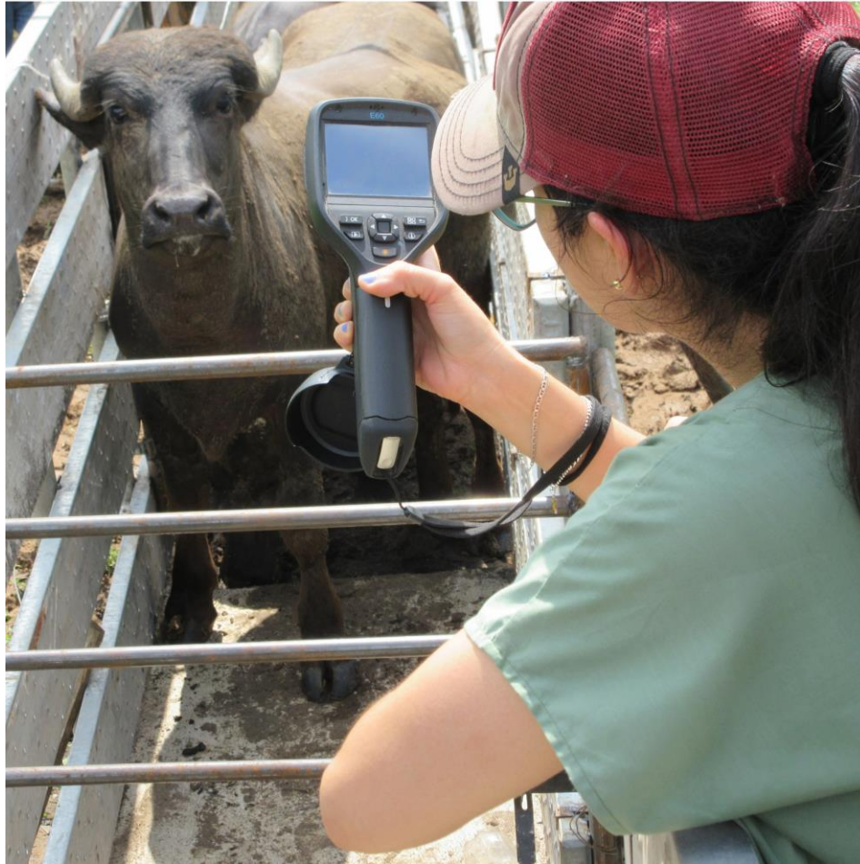
Figura 6. Cámara infrarroja FLIR® Thermal TM E60 (FLIR Systems, EE. UU.) utilizada durante las movilizaciones de búfalos de agua.
