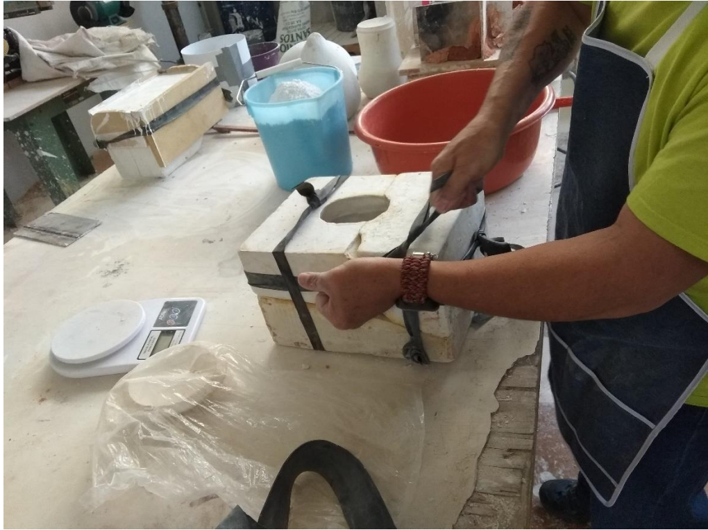
Vaciado para contramolde
