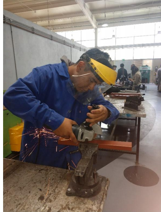
Fabricación de protección de la cinta. Img. 14
