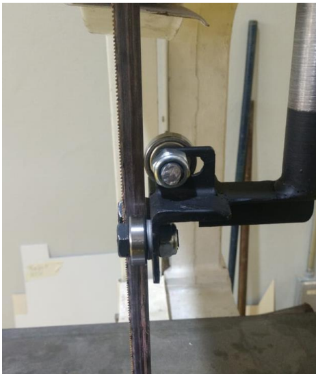
Guía de sierra cinta "Lobo" fabricada y colocada. Img. 27 y 28
