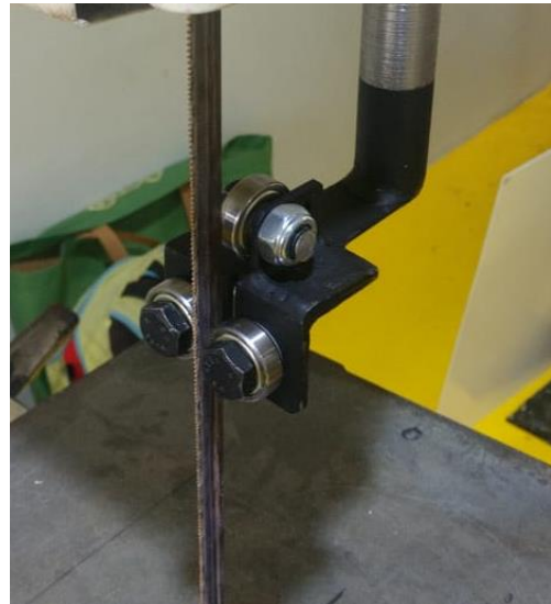
Guía de sierra cinta "Lobo" fabricada y colocada. Img. 27 y 28
