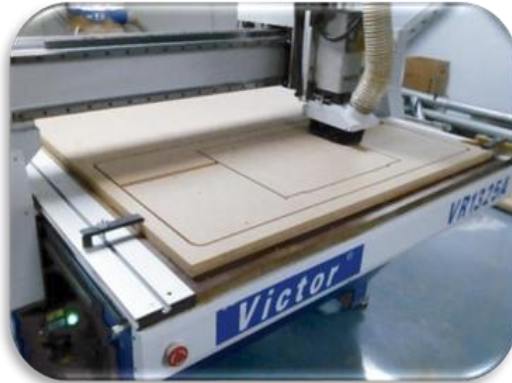
Maquinado en el router del CNC, en MDF de 30 mm Img. 1 y 2
