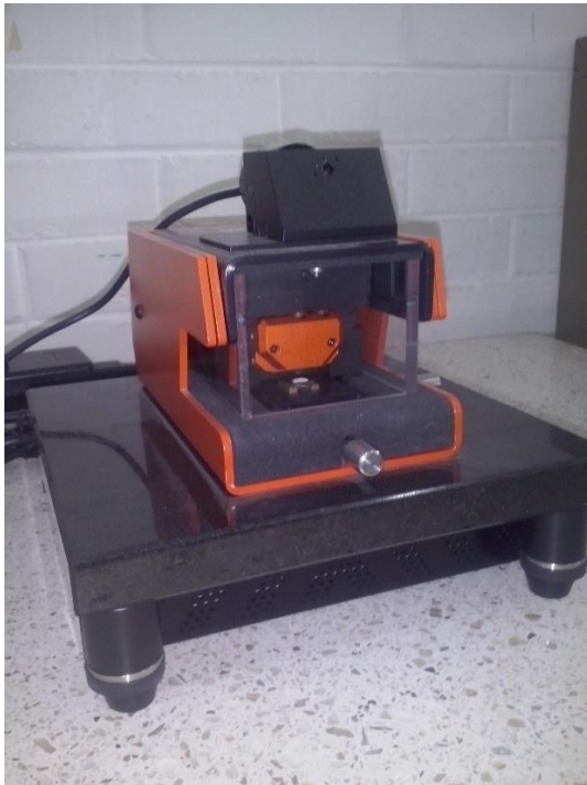
Figura 2: Microscopio de fuerza atómica (NaioAFM) marca Nanosurf. Instituto de Investigaciones en Materiales, UNAM (2023).
