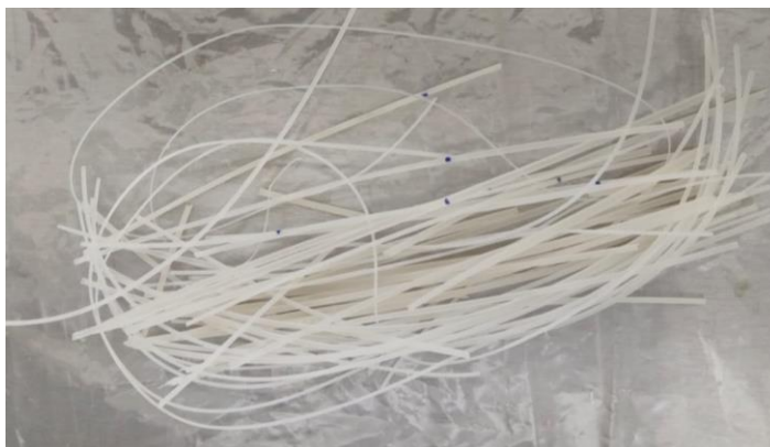
Figura 11. Filamentos de Soluplus ® obtenidos por extrusión
