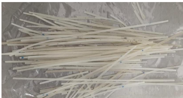
Figura 12. Filamentos de Soluplus ® : HPMC (85:15) obtenidos por extrusión
