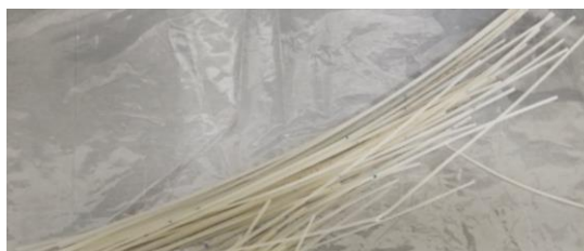
Figura 13. Filamentos de Soluplus ® : HPMC:Losartán Potásico (85:15:5) obtenidos por extrusión
