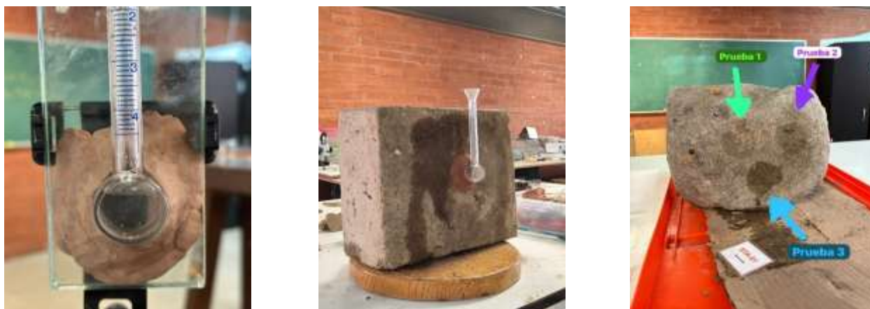
Figura3. Montaje y ensayo de absorción de agua, fijación y sellado del instrumento a la superficie del bloque
