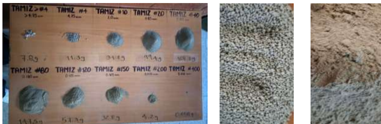
Figura 1. Análisis de pruebas granulométricas por medio de tamices normalizados de mayor a menor abertura
