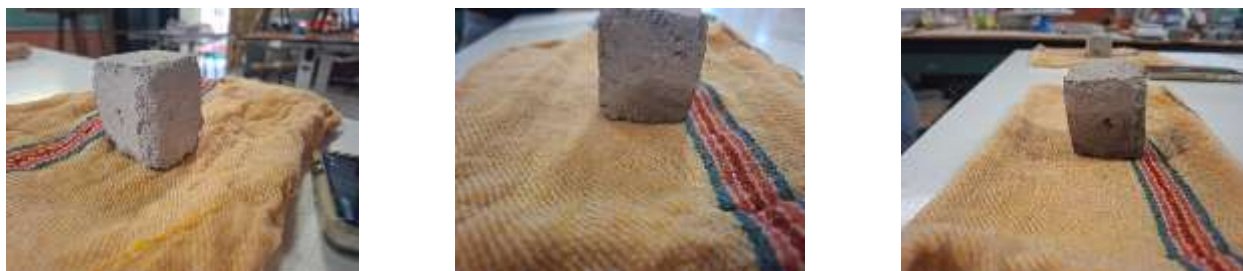
figura2. La prueba se realizó en las diferentes probetas obtenidas de distintos adobes, se coloca un trapo húmedo agregando 5ml de agua cada 3,5,10,15,30 minutos
