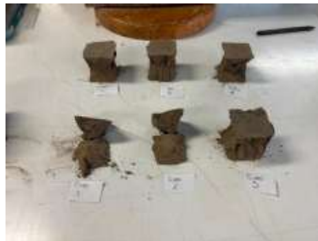
Figura5. Ensayo de resistencia a la compresión de probetas de tierra: Colocación de la probeta en la prensa de ensayo durante la clase impartida por el Dr. Luis Fernando Guerrero Baca, Inspección del fallo y grietas producidas tras la aplicación de carga máxima perpendicular.
