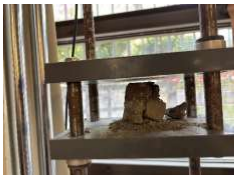
Figura5. Ensayo de resistencia a la compresión de probetas de tierra: Colocación de la probeta en la prensa de ensayo durante la clase impartida por el Dr. Luis Fernando Guerrero Baca, Inspección del fallo y grietas producidas tras la aplicación de carga máxima perpendicular.
