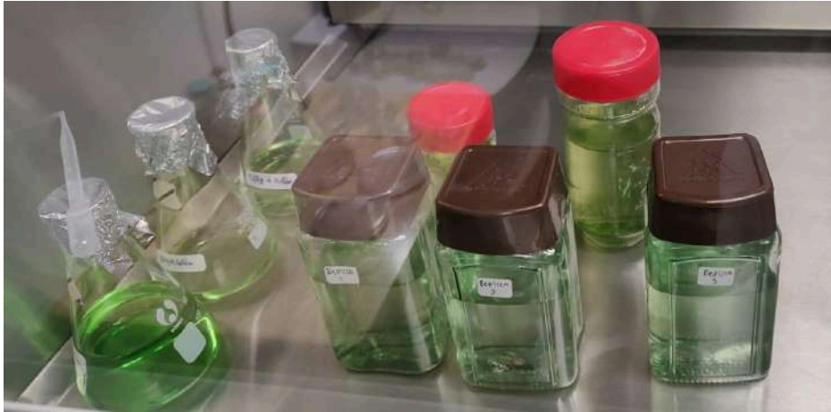
imagen 33. Medios previamente preparados, diluidos y esterilizados para ser utilizados.
