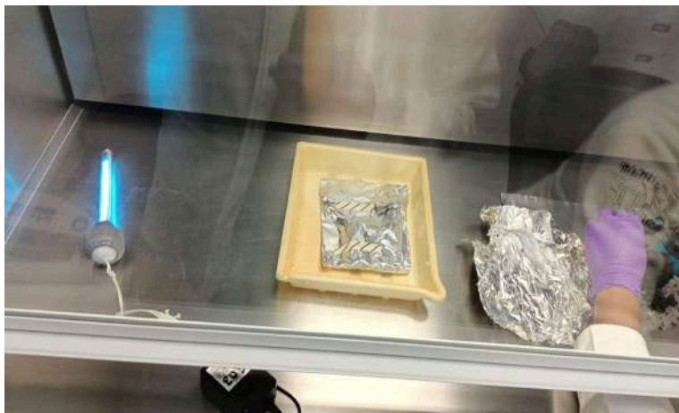
Imagen 18, Esterilización del área de trabajo con luz UV.
