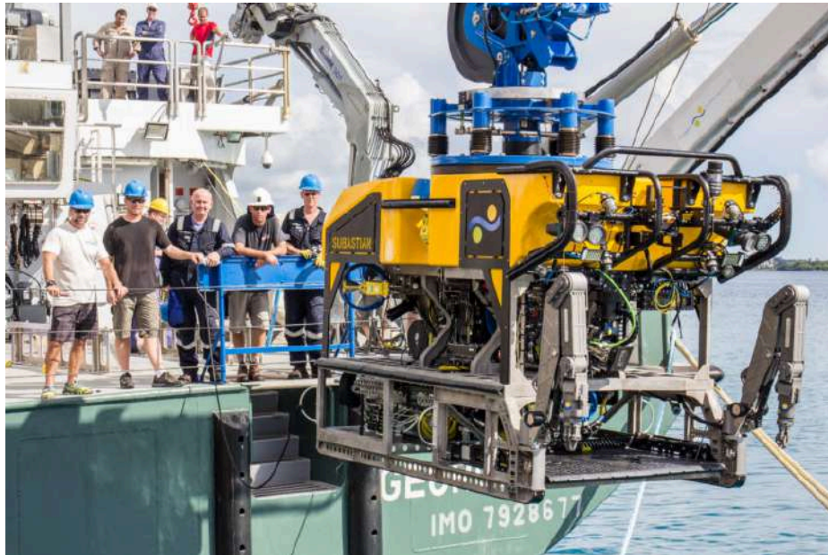
Imagen 8: ROV (remotely operated vehicle) SuBastian. Fotografía obtenida en: https://schmidtocean.org/collection/4500-m-rov/
