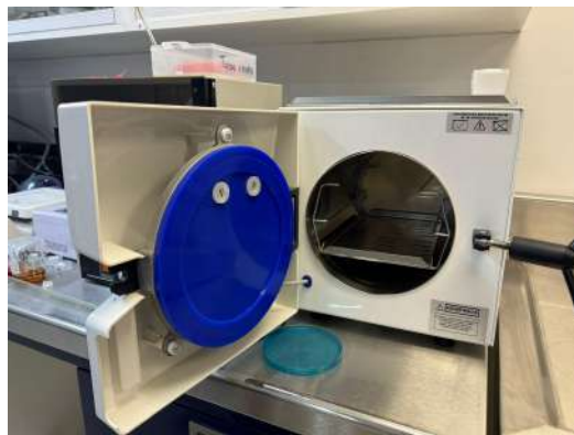
Imagen 16. Autoclave quirúrgico electrónico (Lorma® Modelo AV07).
