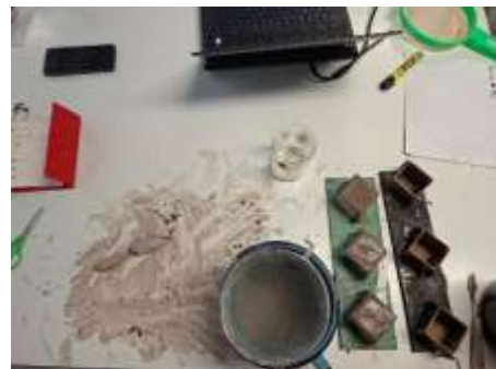
IMAGEN 10.-ELABORACIÓN DE PROBETAS PARA PRUEBAS DE RESISTENCIA.
