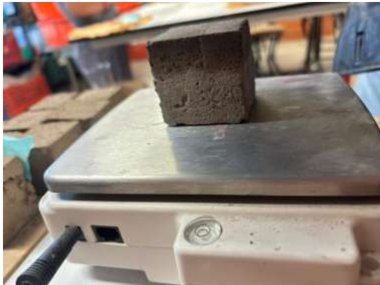
IMAGEN 14.-ANÁLISIS DE PROBETA DESPUÉS DE LA PRUEBA DE CAPILARIDAD.
