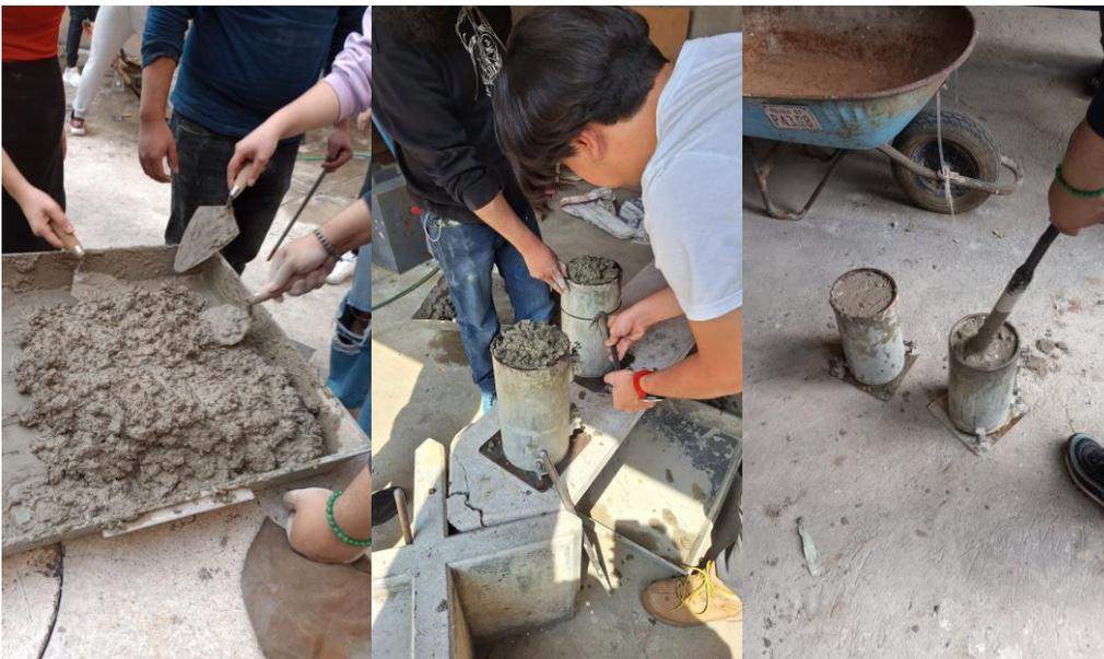
*Cabeceo de cilindros con mortero de azufre y resistencia a la compresión axial*
