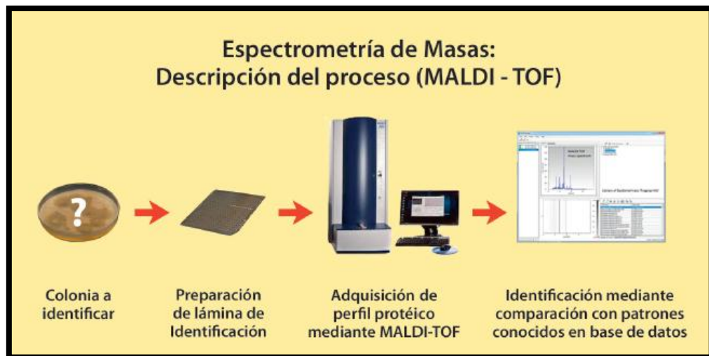
Figura N° 2 Proceso a seguir para la identificación de bacterias mediante el uso de espectrómetro de masas.
